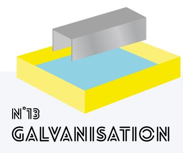
Traitement de surface, par bain ou par bombe, permettant de protéger une pièce de la corrosion, en la recouvrant d'une pellicule de zinc. L'étymologie du mot provient du nom de son inventeur, le physicien italien Luigi Galvani (1737 - 1798).
